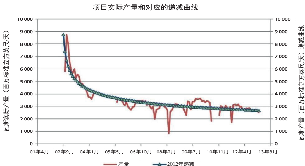
图 3.2 废弃煤矿瓦斯涌出量递减曲线
